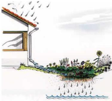
Versickerung über belebte Bodenschicht (*oberflächlich*)
