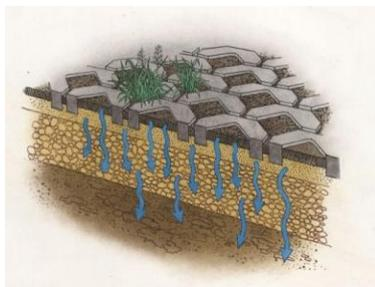
Versickerung über durchlässige Beläge (*flächig / hochliegend*)
