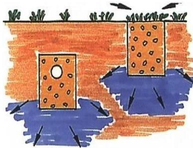
Versickerung über Sickergraben (*Versickerung linear*)
