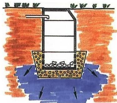
Versickerung über Sickerschacht (*Versickerung konzentriert*)
