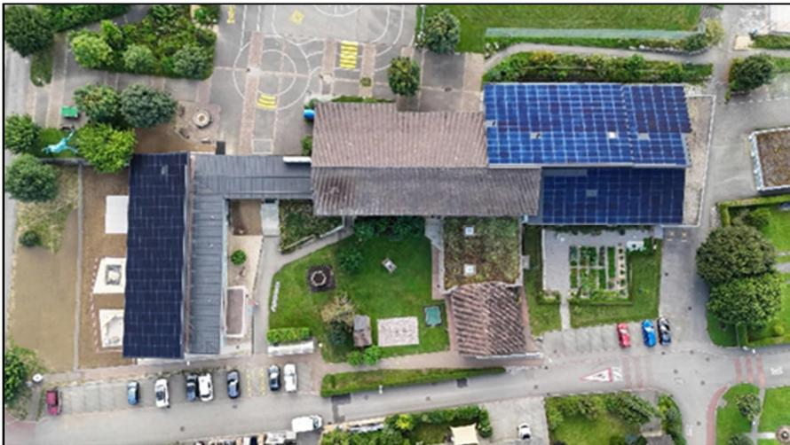
Im Rahmen der Sanierung der Primarschule Zunzgen soll auch das Dach des Mitteltrakts mit einer dachintegrierten PV-Anlage ausgerüstet werden. Die geplante Anlage hat eine Leistung von 122 kWp. Die Stromproduktion ergibt einen jährlichen Betrag von ca. CHF 18'000. Abzüglich der Eigenkapitalkosten ist die Anlage damit in ca. 18 Jahren amortisiert.
