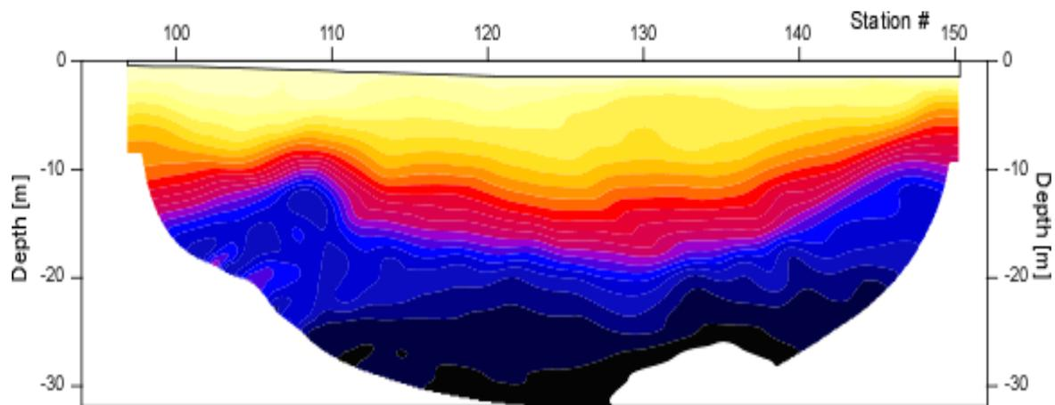
Für die Überprüfung der Grundwasserschutzzonen der Einwohnergemeinde Zunzgen wurden im Grenzbereich Zunzgen – Tenniken drei seismische Profile mit einer Gesamtlänge von rund 700 m gemessen und ausgewertet.
