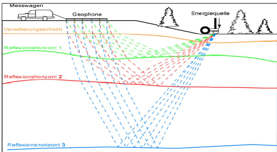
Die aus der Mehrfachüberdeckung resultierende Datenredundanz kommt bei der nachfolgenden EDV dadurch zum Tragen, dass mittels einer Montage von allen Sender-Empfänger-Seismogrammen ein Tiefenschnitt (*seismic section*) vom Untergrund erstellt wird, der mit einer Röntgenaufnahme vergleichbar ist.
