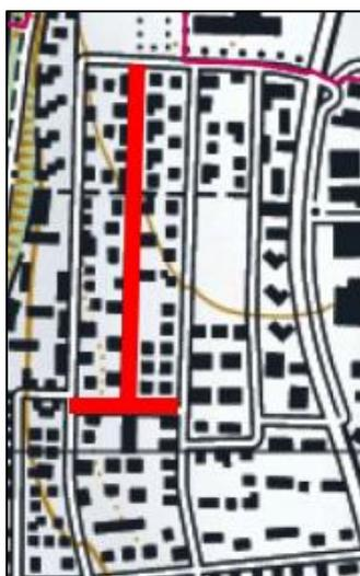
Aufgrund des Alters sowie der Materialbeschaffenheit der bestehenden Wasserleitung (Baujahr 1981, Duktiguss) im Mittelfeldweg / Moosackerweg und mehreren Lecks in den letzten Jahren, soll die Leitung durch eine neue PE Wasserleitung ersetzt werden.
