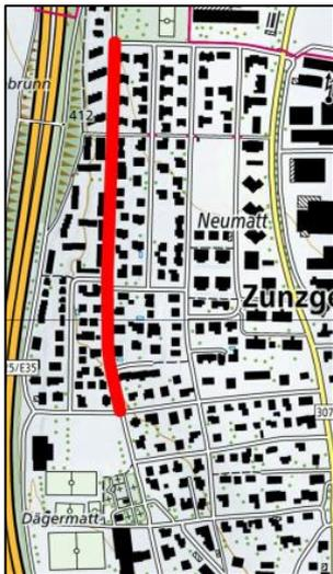
Aufgrund des Alters sowie der Materialbeschaffenheit der bestehenden Wasserleitung (Baujahr 1968 bis 1988, Grau-/Duktilguss) im Steinenweg und mehreren Rohrleitungsbrüchen in den letzten Jahren, soll die Leitung im Abschnitt Ringstrasse bis Aufgendsweg durch eine neue PE Wasserleitung ersetzt werden. Die bestehende Kanalisationsleitung im selbigen Abschnitt wird wo nötig und im gleichen Zuge saniert. Stellenweise ist die Erneuerung der Strassenkoffierung und der Randabschlüsse erforderlich.
