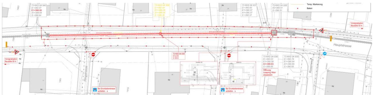
Der motorisierte Verkehr wird hier einstreifig um die Baustelle geführt und mit einer Lichtsignalanlage geregelt. Alle Zufahrten zu den Liegenschaften werden, bis auf kurze Unterbrüche, gewährleistet sein.
