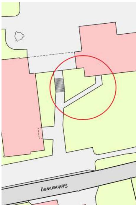
Im Bereich des Eingangs werden zwei neue Flügelmauern mit Längen von ca. 2.60 und 3.60 m und einer Höhe von ca. 1.20 m aus Ortsbeton erstellt.
