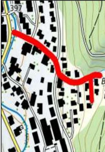
**Strasse:** Gemäss «Werterhaltung Tiefbau» sieht die Zusammenstellung für die Strasse insbesondere im unteren Teil «kurzfristige Massnahmen» vor. Diese Arbeiten (teilweise Ersatz der Foundationsschicht, von Randabschlüssen sowie die örtlichen Belagserneuerungen) können im Zuge der Tiefbauarbeiten für die neue Wasserleitung ebenfalls ausgeführt werden.
