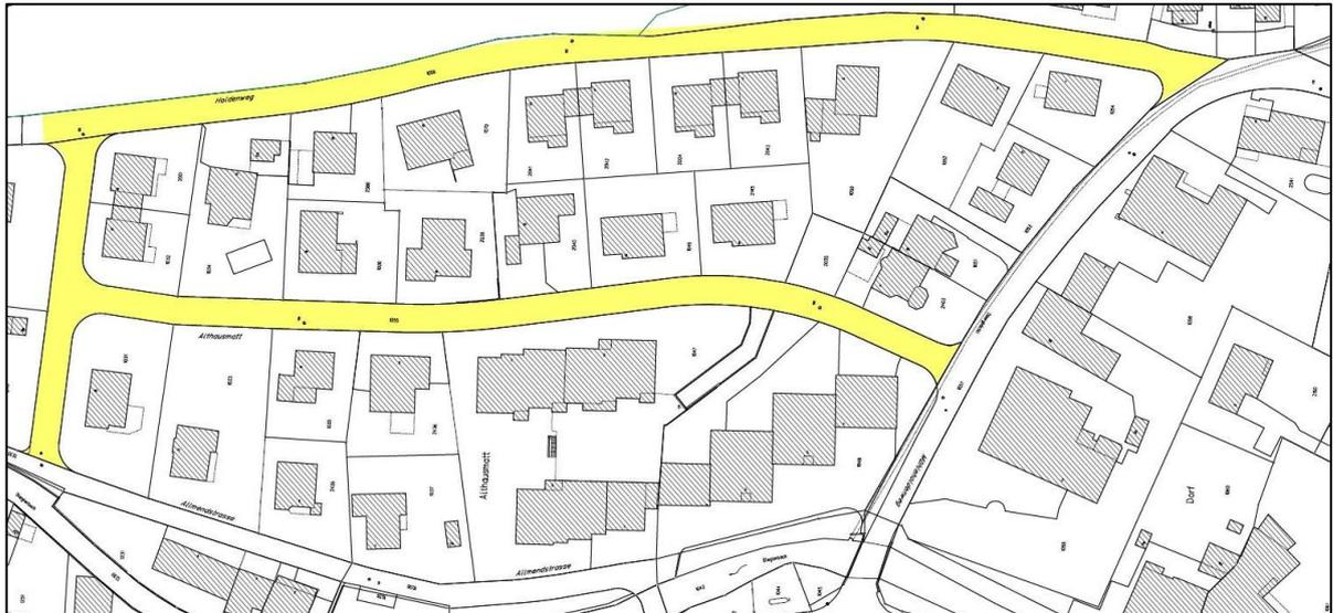
Die Trinkwasserleitung hat ihre technische Nutzungsdauer erreicht. In der Vergangenheit mussten schon diverse Lecks saniert werden, weshalb die Leitung erneuert werden soll. Die bestehenden Schmutzwasserleitungen sind gemäss Zustandserfassungen in einem teilweise schlechten Zustand und sollten ebenfalls saniert werden.
